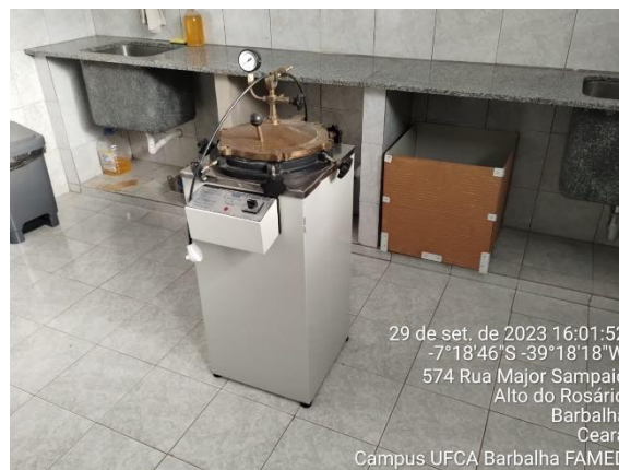
Figura 3. Autoclave na Sala de Esterilização (piso superior do prédio principal)
