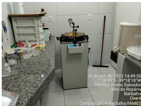
Figura 2 Autoclave no Lapex (térreo do prédio principal).
