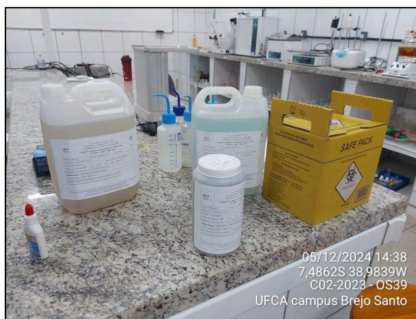
Figura 7 - Embalagens padronizadas para acondicionamento de resíduos químicos e perfurocortantes
