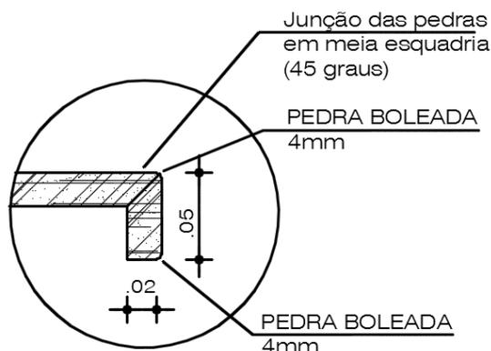
A massa plástica utilizada na junção das peças de granito deve ser da cor do granito assentado e deve receber polimento após secagem, sempre de modo a resultar em uma superfície de cor e textura homogênea. A FISCALIZAÇÃO não deve aceitar a pedra com buracos, riscos ou pedaços de massa melados na superfície. A CONTRATADA deve se certificar de que qualquer imperfeição na pedra foi corrigida e sobras de massa plástica e rejunte foram retirados.
