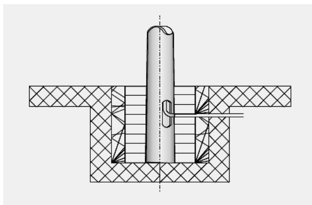
O topo dos postes de concreto receberão suporte metálico conforme figura. Os suportes serão confeccionados em ferro galvanizado com acabamento em pintura eletrostática esmalte cor branca, obedecendo a geometria e comprimento estabelecidos no projeto luminotécnico. Observar que se deve adquirir as luminárias antes de confeccionar o suporte, para dimensionar a conexão. Exemplo de suporte para duas luminárias abaixo:
