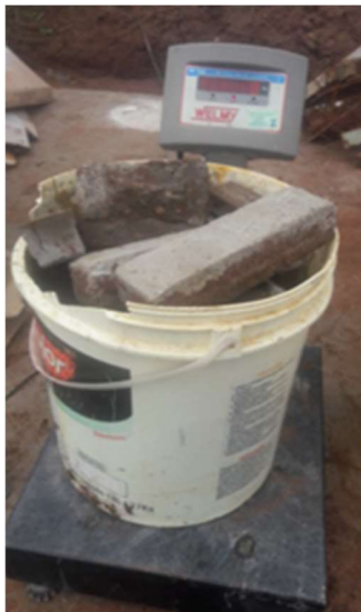
Figura 5 - Pesagem dos RCCs em canteiro de obras
