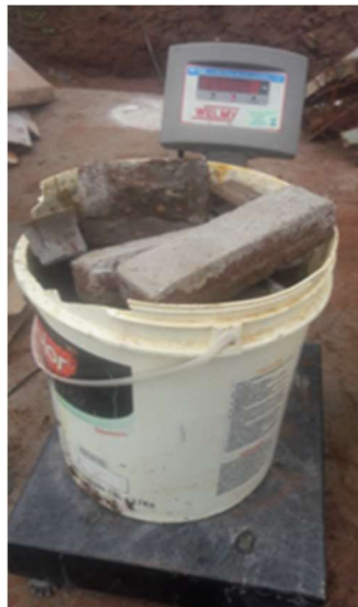
Figura 5 - Pesagem dos RCCs em canteiro de obras
