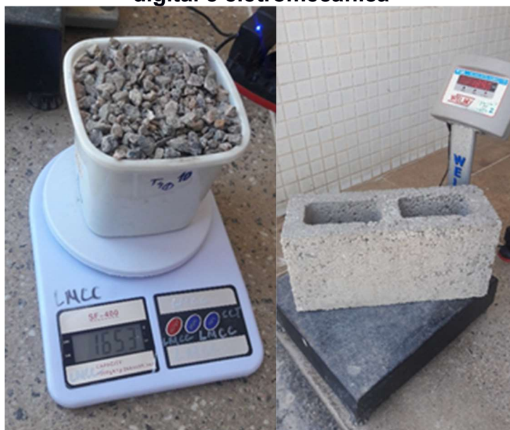
Figura 6 - Pesagem dos RCCs dos laboratórios, com a utilização de balanças, digital e eletromecânica
